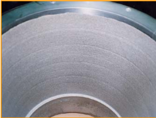
Sandblæst overflade, sporerne er næsten slidt væk
