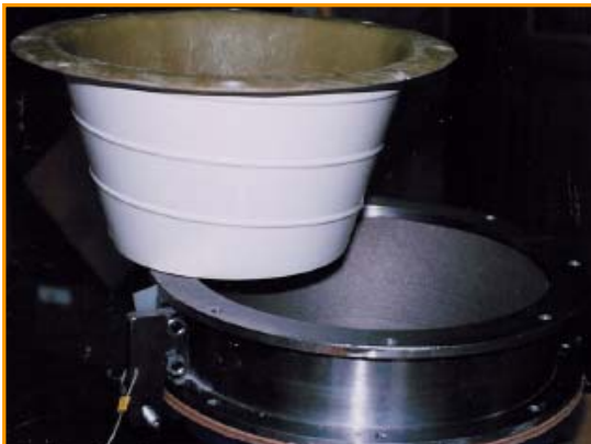
Støbeform klar til montering
