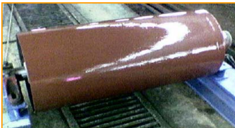
Tromle påført Comtec 432
